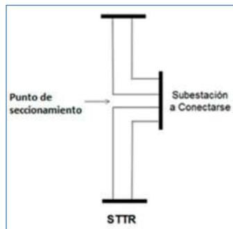
Figura 2.3 Tipo de Derivación en "PI ()"
